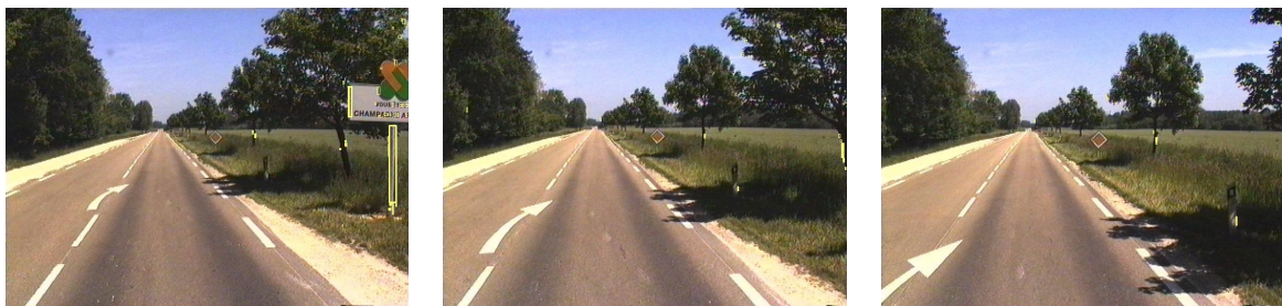
FIG. 4.16: Pré-détection par mesures de forme verticales : l'ombre portée sur le délinéateur atténue ses contours et empêche sa détection.
